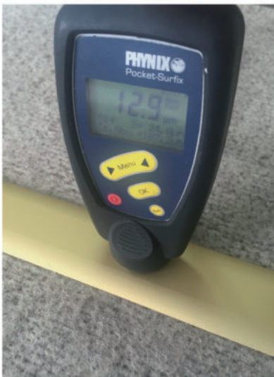
Anodising thickness test 氧化膜厚测量
